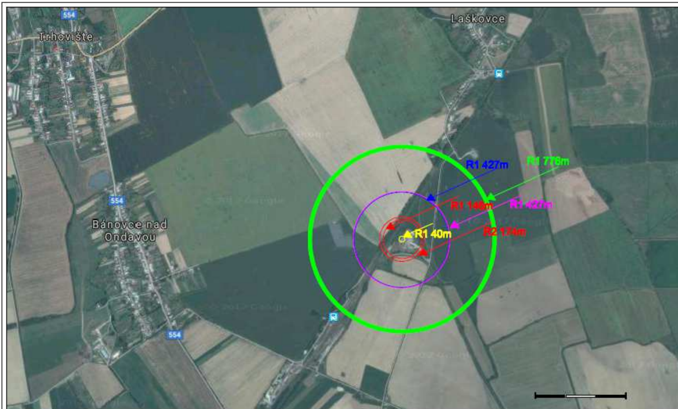
Obr. 1 Dosahy havarijného scenára – železničná cisterna
