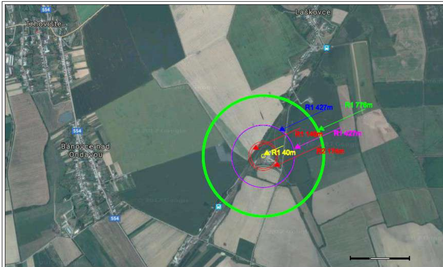
Obr. 1 Dosahy havarijného scenára – železničná cisterna
